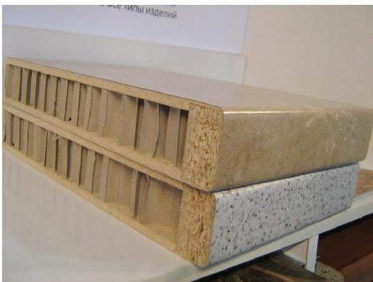
Кстати, каменные столешницы для кухни изнутри выглядят примерно так же. Сверху тонкий слой искусственного камня и спереди наклеен торец, имитирующий толщину столешницы. Внутри же обычное ДСП.
